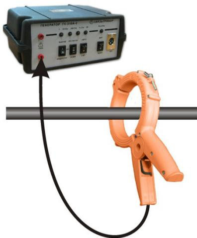
При таком подключении достигается более высокий уровень сигнала в линии и значительно снижается влияние на соседние магистрали.
