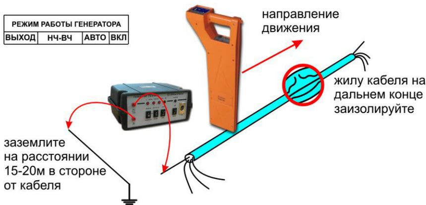
Подключите генератор к поврежденной паре. При этом рекомендуется работать на максимально коротком участке кабеля, чтобы уменьшить паразитный сигнал через емкость кабеля. Желательно, чтобы дефект был ближе к дальнему от генератора концу кабеля.
