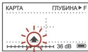
Ситуации когда уровень усиления устанавливается на уровне 64-70Дб означает, что в искомой коммуникации не создается ток достаточный для трассировки. Соответственно подключение генератора сделано неверно либо рабочая частота низкая для данного случая. Попробуйте другие способы подключения генератора либо увеличьте рабочую частоту.
