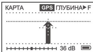
В соответствии с включением «Запись файла» и «GPS» в меню «Настройка», на экране могут быть показаны: глубина залегания кабеля, значение сигнального тока, координаты места и номер записи.
