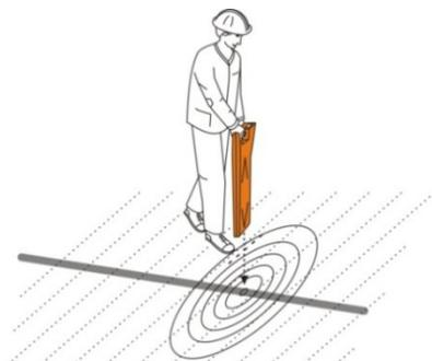
Для точного определения направления залегания трассы поверните приемник из положения максимального сигнала в положение минимального сигнала. В этом случае приемник будет расположен точно вдоль трассы, что и укажет ее направление.
