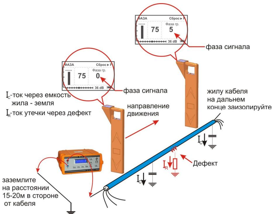
Генератор подключите к кабелю в соответствии с рисунком. Включите генератор, установите переключатель «ИНДУКТОР»-«ВЫХОД» в положение «ВЫХОД», переключатель частоты установите в положение «2kHz-PAUSE» или «2kHz». Мощность установите на максимум - «10 W». В процессе работы его всегда можно будет уменьшить.
