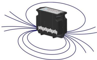
Установите генератор на земле перпендикулярно кабелю или трубе. Включите генератор, установите переключатель «ИНДУКТОР»-«ВЫХОД» в положение «ИНДУКТОР», переключатель частоты установите в положение «2kHz» или «2kHz-PAUSE», при этом встроенный индуктор излучает переменное магнитное поле, которое порождает ток в коммуникации (показано на рисунке). Поле, возбуждаемое током контролируется трассоискателем.
