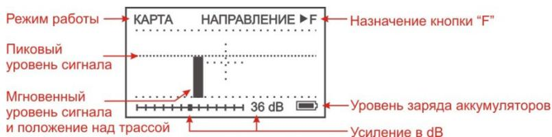
Встаньте с приемником над трассой в направление движения от генератора к дальнему концу кабеля. Нажав кнопку **F**, зафиксируйте направление. Уровень сигнала примет вид стрелки.
