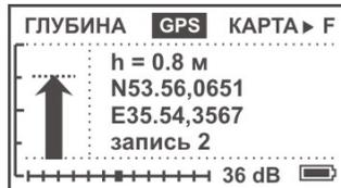
Для получения правильных показаний глубины и значения сигнального тока прибор необходимо расположить точно над трассой, приемник расположить вертикально и под прямым углом к линии. Установите уровень сигнала так, чтобы обеспечить не менее 60-80 единиц на шкале прибора.
