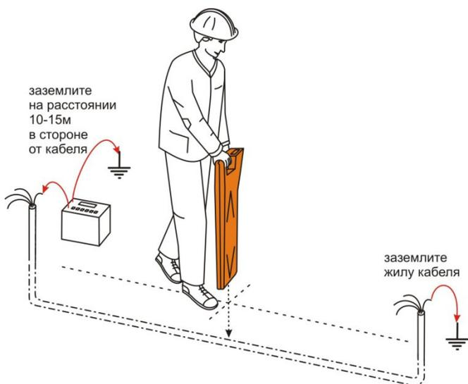
Штырь заземления относится на 10 - 20 м в сторону от трассы. Жилу кабеля на дальнем конце следует заземлить. В качестве заземлителей используется защитное заземление или штырь заземления. На работающем кабеле генератор сигналов подключают к металлической оболочке, либо экрану кабеля.
