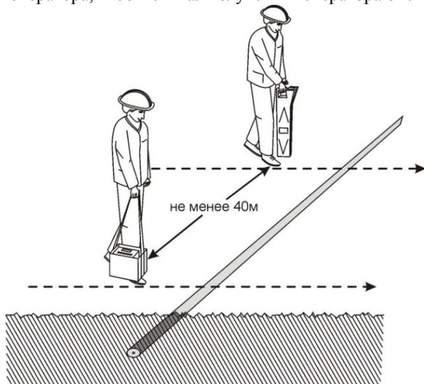
Генератор МК310 (ГК-310А-2) оснащен встроенным аккумулятором и индуктором. Специальная сумка для переноса генератора и позволяет перемещать его в любую точку обследуемой территории. Индуктор расположен в нижнем отсеке корпуса. Генератор следует ставить на землю в вертикальном положении, как показано на рисунке (не вынимая из сумки).
