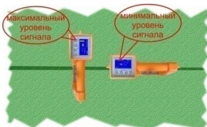
Для точного определения направления залегания трассы поверните приемник из положения максимального сигнала в положение минимального сигнала. В этом случае приемник будет расположен точно вдоль трассы, что и укажет ее направление.
