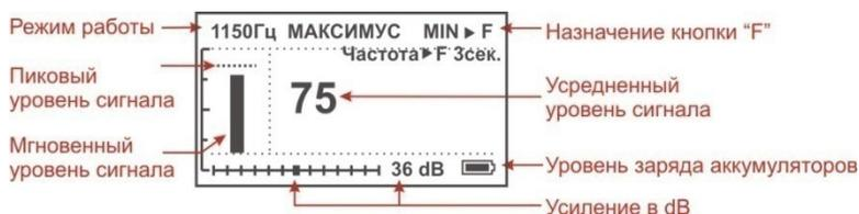
Режим позволяет выбрать частоту принимаемого сигнала от 200 Гц до 26 000 Гц. Для изменения частоты нажмите **F** и удерживайте примерно 3 секунды. Кнопками **▲** или **▼** установите необходимое значение разряда, переместитесь на следующий разряд, нажав **F**. Для сохранения новой частоты сигнала и возврата нажмите кнопку **OK**.
