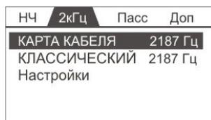
В верхней части отображаются рабочие частоты прибора. Переключение происходит нажатием кнопки
