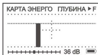
При нахождении точно над кабелем нажмите кнопку
