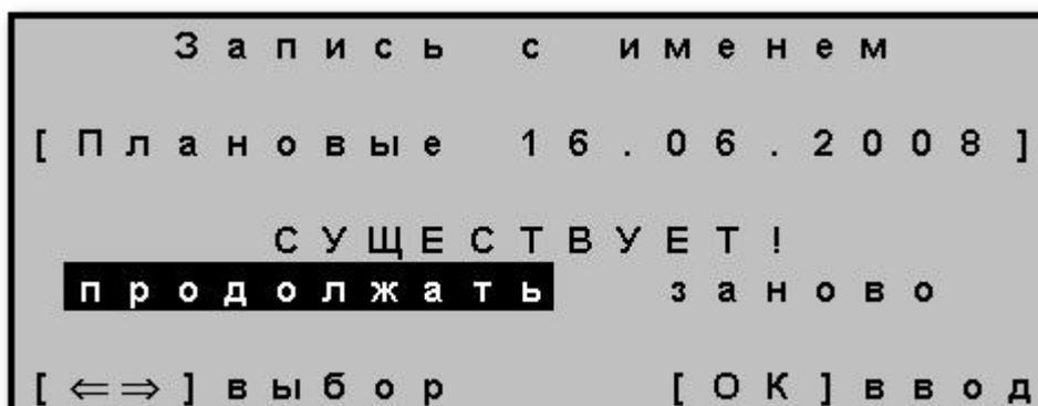
При выборе варианта «продолжать» уже имеющиеся результаты будут пополняться или заменяться (при проведении повторных измерений по тем же парам), при выборе «заново» ВСЕ проведенные измерения по выбранному кабелю будут затерты.
