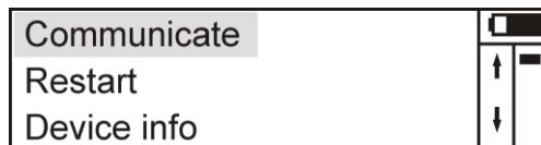
Для входа в режим обновления выберите “Communicate”. В этом режиме прибор устанавливает свой IP адрес на 192.168.0.253 с маской 255.255.255.0.
