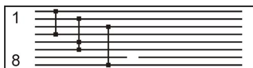
На экран будет выведена карта проводов. При наличии замыкания между соответствующими жилами будет перемычка. Если жила оборвана или на удаленном конце не подсоединен оконечник, то на ней будет показан обрыв.
