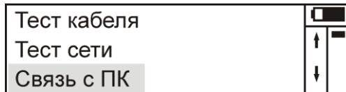
Прибор оснащен интерфейсом связи с ПК для передачи настроек прибора на персональный компьютер, работающий под управлением операционной системы семейства Windows, Linux.
