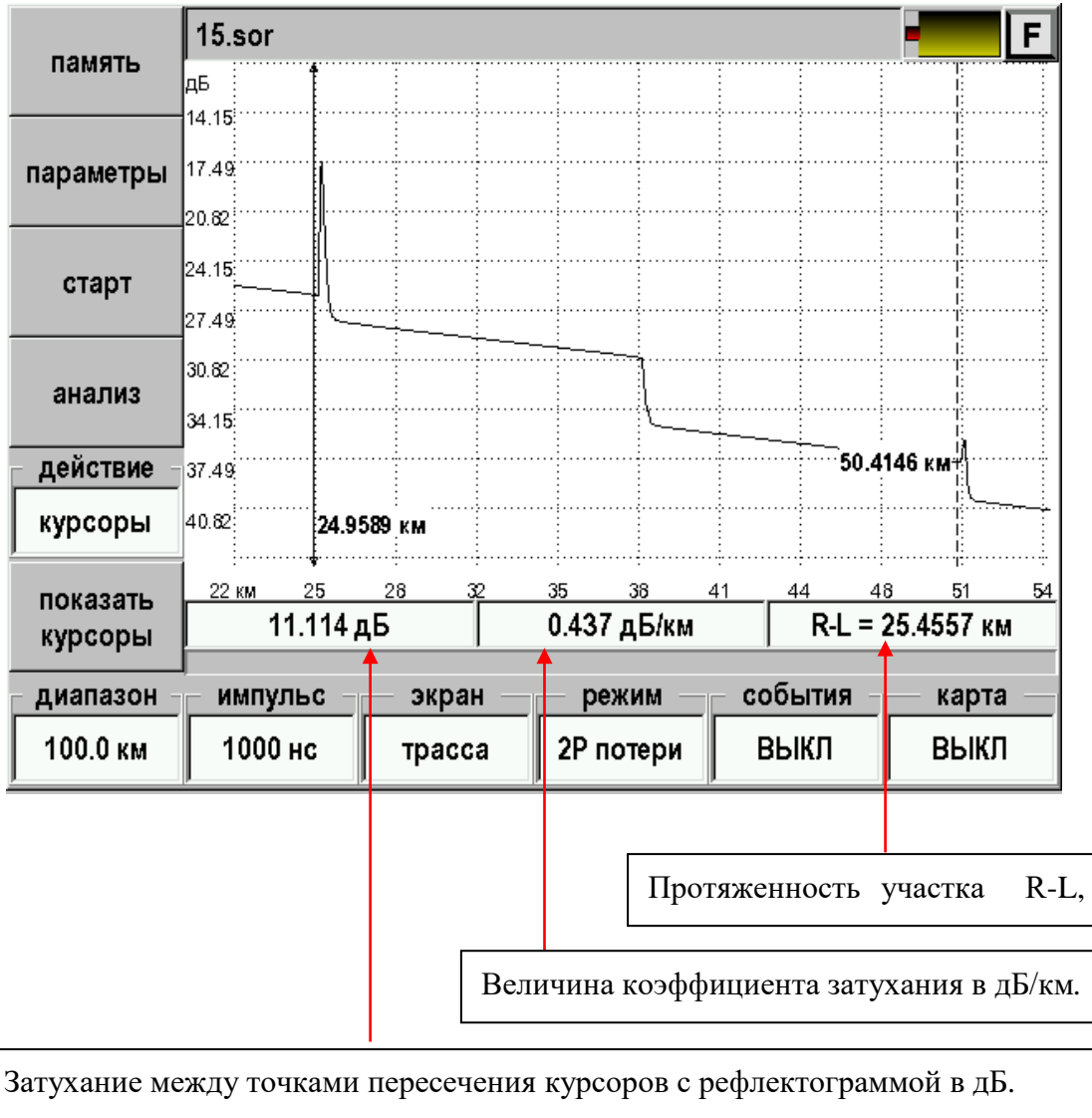
Рис. 31. Измерение затухания по двум точкам.
