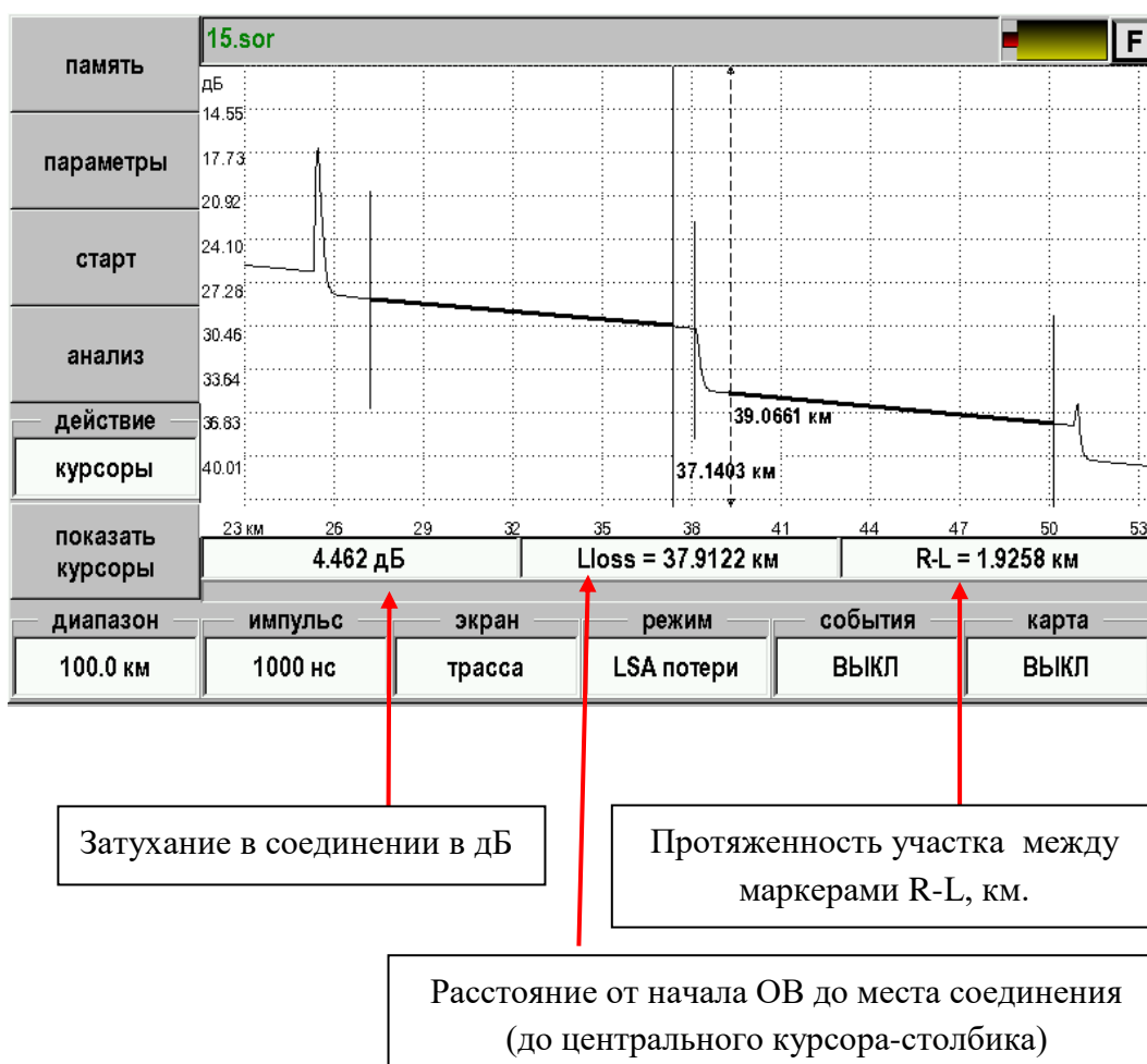
Рис. 35. Измерение затухания в соединении ОВ.
