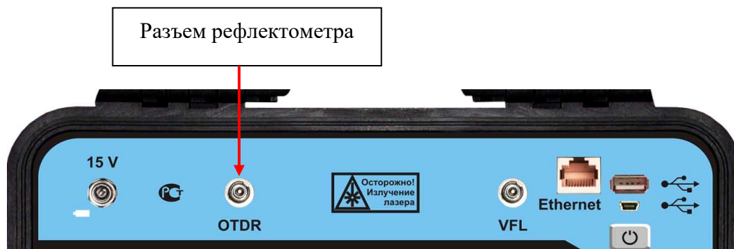
Рис. 12. Подключение оптического волокна.
