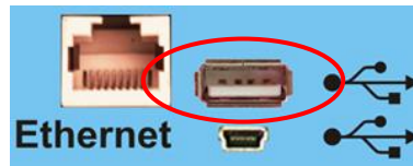
Рис. 7. Подключение компьютерной мыши к прибору.
