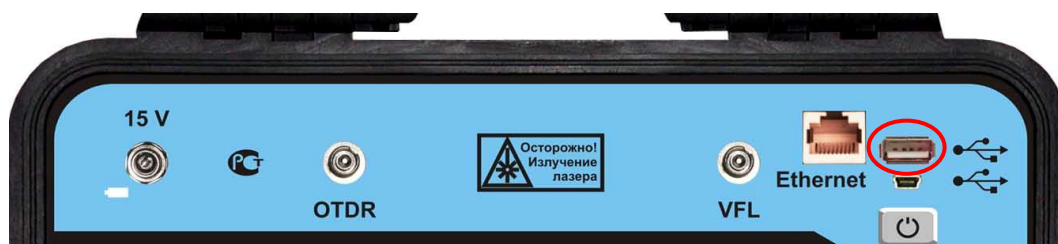
Рис. 50. Подключение Flash накопителя.
