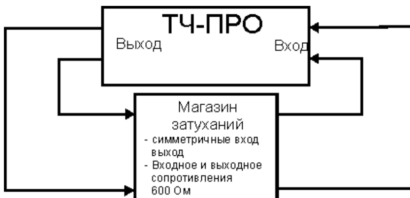
Рисунок 8.4. Проверка измерителя уровня с использованием магазина затухания.
