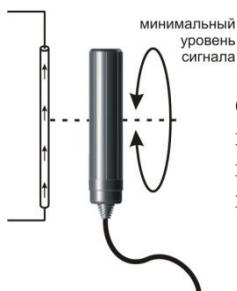
**Определение направления прокладки кабеля:** при вращении отборника вокруг своей оси над кабелем, положение с минимальным уровнем сигнала покажет направление прокладки кабеля.
